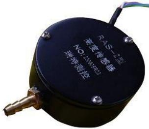
RAS-2 气压高度计是研制生产、用于测量海拔高度的气压高度计。选用高精度压力传感器，采用高性能 MCU 对检测数据进行分析、处理、计算，并在全工作温度范围（-50℃~+85℃）对检测信号进行温度补偿，最终得到的高度信号经过 RS422/RS232（可选）接口输出。产品具有数字式输出、精度高、适应温度范围宽、互换性强、年稳定性好、体积小、功耗低、抗潮湿、抗冲击、抗振动性能好的特点。主要应用在汽车高度测量仪、海拔高度测量仪器、捷联惯导系统。
