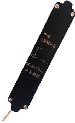
RMC160 型测斜仪用传感器采用先进的数字技术和磁感应传感器设计的最新成果，磁感应传感器具有体积小、灵敏度高、线性度好、带宽宽、可靠性高等优点；内置了先进的硬磁校准方法，使得在较为恶劣的磁环境情况下能够保证输出航向的准确性，具有模拟电路难以实现和无法比拟的优势；该传感器为铝质外壳设计，体积小、重量轻、安装简便，每只传感器在出厂前都进行了温度漂移与灵敏度曲线的修正和全数字补偿，达到了宽温度工作和高精度的有效结合；设计的数字输出接口有 RS-485 和 RS-232 以及 UART 三种可以选择。用于煤矿、地质、油田测斜仪等领域。
