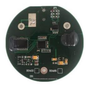
RMR2300型三轴磁传感器采用先进的数字技术和磁感应传感器设计的最新成果,磁感应传感器具有体积小、灵敏度高、线性度好、带宽宽、可靠性高等优点。设计的数字输出接口有 RS-422 和 RS-485 两种可以选择。该产品可以用于电子罗盘、姿态航向参考系统、汽车电子、导弹制导和控制、智能炸弹、飞行器稳定控制、天线稳定和无人机飞行等领域的方向测量与控制等系统。
