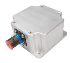
RIU200 型数字式惯性测量单元是采用微机电系统(Micro Electro-Mechanical System, MEMS)技术、自行研制的高精度六自由度惯性测量系统。系统的可靠性高,性能稳定,结构紧凑,包含三个采用微机械技术加工的角速率陀螺和三个加速度计,采用数字信号处理技术对各传感器进行降噪、温度补偿、非线性校正和交叉耦合补偿,最终通过RS422接口以数字量实时输出载体的三维角速率和三维线加速度。在全温度范围(-55°C~+85°C)内,采用数字信号处理器进行传感器原始信号的校正、补偿(零位、刻度因数、安装误差)、降噪等处理。特点包括采用宽直流电源输入设计、抗振动冲击、体积小。应用于平台稳定、运动控制系统、船舶、车辆的稳定与控制、惯性制导与导航、姿态航向参考系统(AHRS)。
